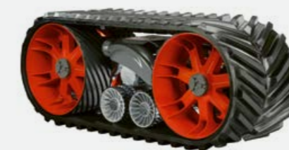
TERRA TRAC 890 mm con design a raggi
