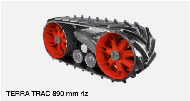
TERRA TRAC 890 mm avec roues à rayons
