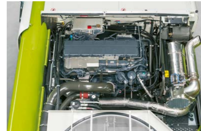
MAN D42 581 kW / 790 hv LEXION 8900 mallissa.
