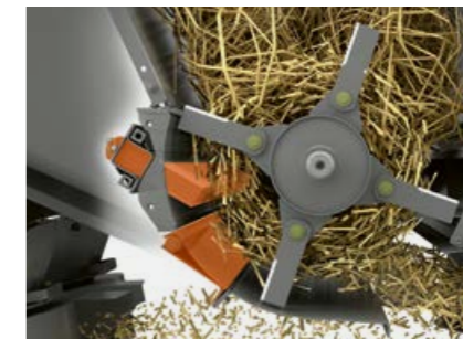
SPECIAL CUT silppurin vastaterä ja käännettävä pohjaosa.
