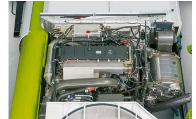
Mercedes Benz OM 473 460 kW / 626 hv LEXION 8700 mallissa.
