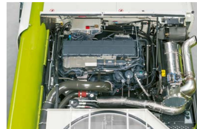
MAN D42 con 581 kW / 790 CV para LEXION 8900.
