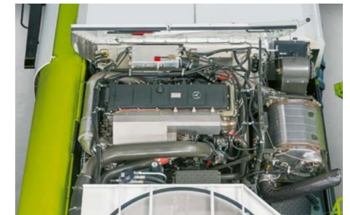
Mercedes Benz OM 473 con 460 kW / 626 CV para LEXION 8700.
