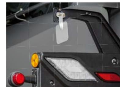
Sensor der automatischen Wurfrichtungsanpassung
