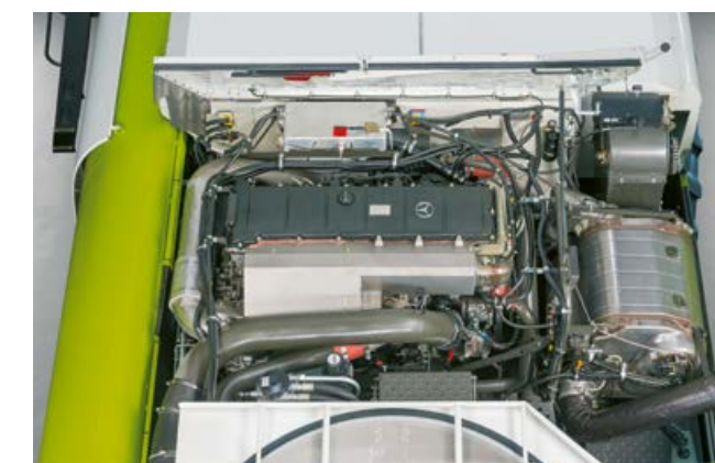
Mercedes Benz OM 473 s 460 kW / 626 k pro LEXION 8700.
