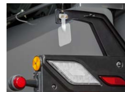
Senzor automatického přizpůsobení směru odhozu.
