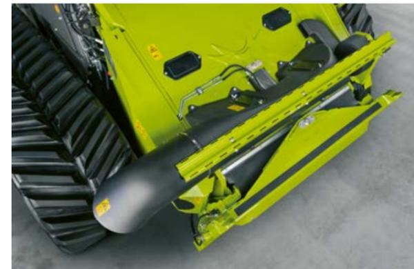
**Convoyeur à face avant réglable renforcé.**
