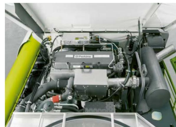
Moteur Perkins 2206D jusqu'à 420 kW / 571 ch.
