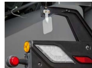
Capteur de régulation automatique de la direction d'épandage.
