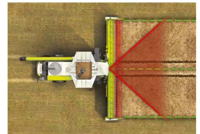
LASER PILOT avec FIELD SCANNER
