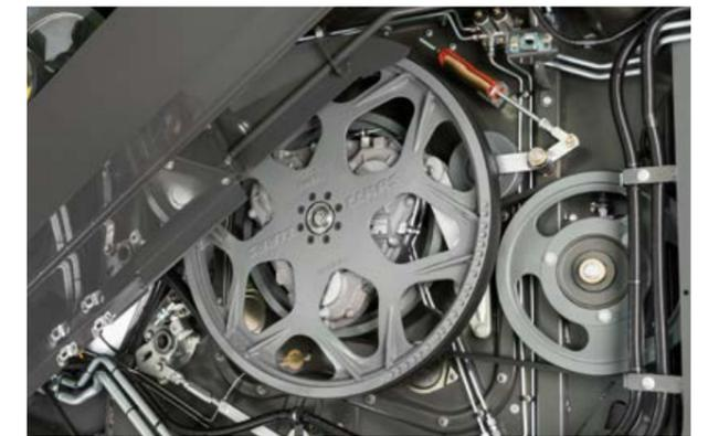
Même lorsque le régime est réglé par voie mécanique, aucun outil n'est nécessaire. Et pour gagner encore plus de temps, rien de mieux que le réglage hydraulique (option), qui vous permet d'adapter le régime depuis la cabine.
