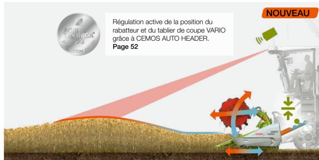
Régulation active de la position du rabatteur et du tablier de coupe VARIO grâce à CEMOS AUTO HEADER. **Page 52**
