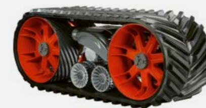
TERRA TRAC 890 mm, koła w kształcie gwiazdy
