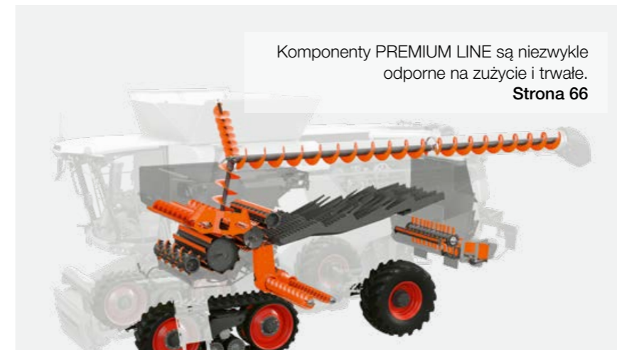
Przenośniki taśmowe w kanale wciągającym zapewniają spokojniejszą pracę i trwałość. Strona 16
