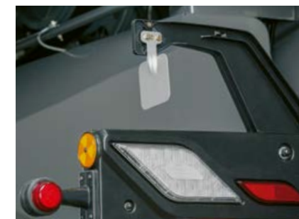
Sensore dell'adeguamento automatico della direzione di lancio.
