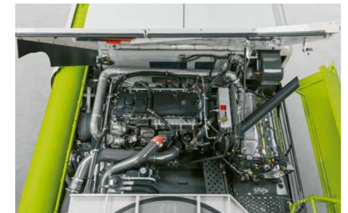
Mercedes-Benz OM 470 da 300 kW / 408 CV per LEXION 6700.
