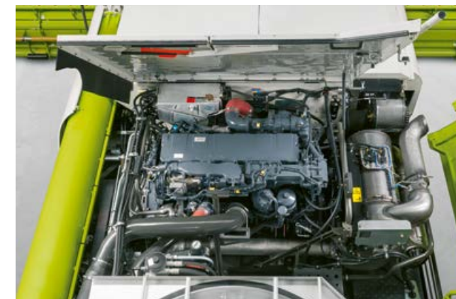
MAN D 26 da 373 kW / 507 CV per LEXION 6900.
