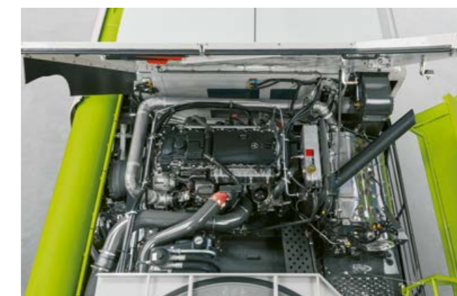
LEXION 6700 avec moteur Mercedes-Benz OM 470 LA de 300 kW / 408 ch.
