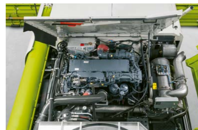
LEXION 6900 avec moteur MAN D26 de 373 kW / 507 ch.
