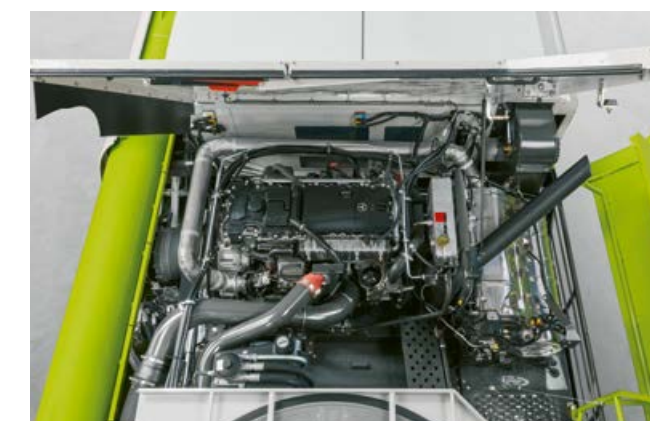
Mercedes-Benz OM 470 s 300 kW / 408 k pro LEXION 6700.
