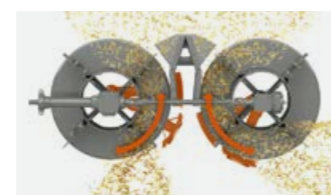
Rozdzielacz promieniowy dla wydajnego rozdzielania słomy przy minimalnym nakładzie siły.
