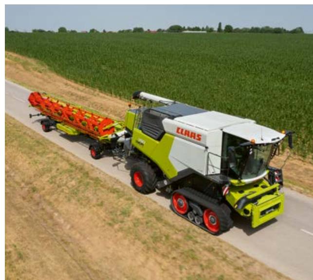
Visos TERRA TRAC vikšrinės važiuoklės yra pritaikytos važiuoti keliais iki 30 km/h greičiu, o važiavimo komfortas yra didesnis nei ratinių mašinų.
