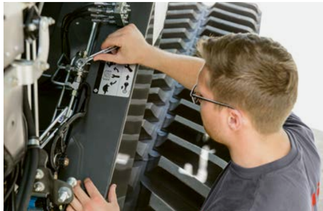
Du kūlimo būgno reduktoriaus greičio diapazonai perjungiami rankiniu būdu, naudojant hidraulinį vožtuvą.
