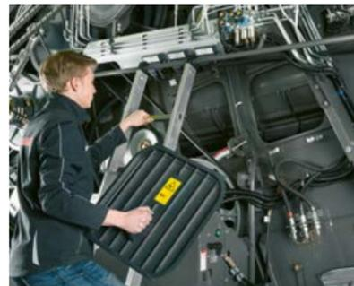
Points d'ancrage multiples pour l'échelle mobile.
