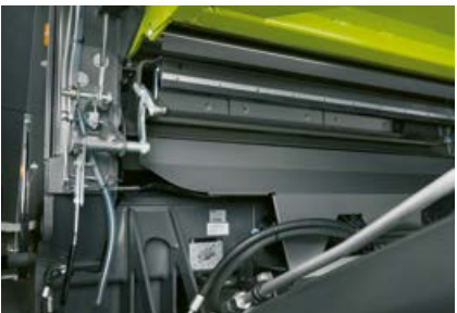
Grand bac à pierres facile à ouvrir et à vider.
