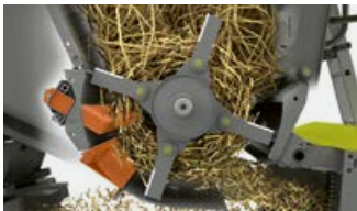
Broyeur SPECIAL CUT avec contre-couteau et fond rotor à élément escamotable
