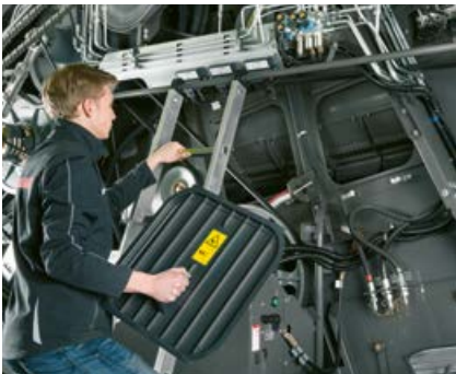
Points d'ancrage multiples pour l'échelle mobile.
