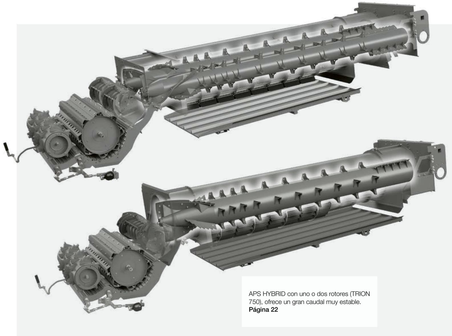
APS HYBRID con uno o dos rotores (TRION 750), ofrece un gran caudal muy estable.
