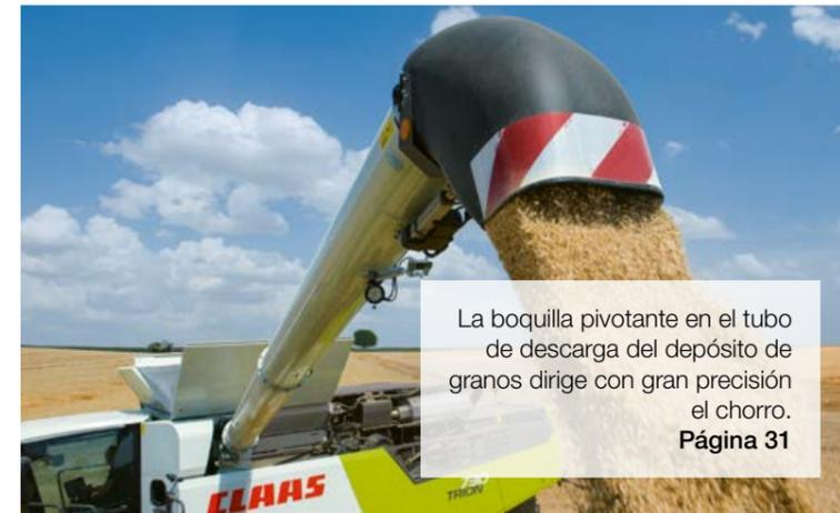
La boquilla pivotante en el tubo de descarga del depósito de granos dirige con gran precisión el chorro.
