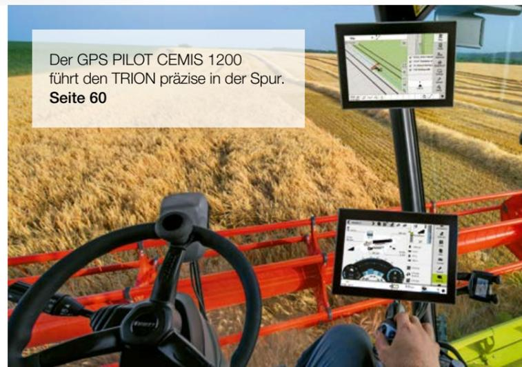
Der GPS PILOT CEMIS 1200 führt den TRION präzise in der Spur.
