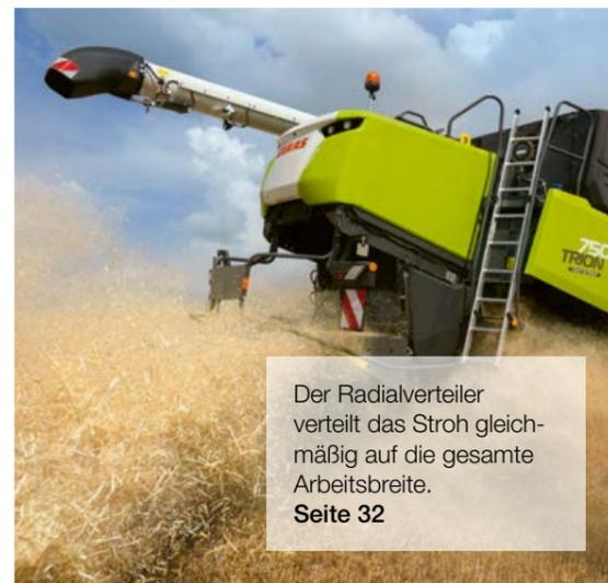
Der Radialverteiler verteilt das Stroh gleichmäßig auf die gesamte Arbeitsbreite.
