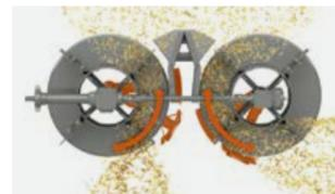
Radialverteiler für effiziente Strohverteilung bei minimalem Kraftaufwand
