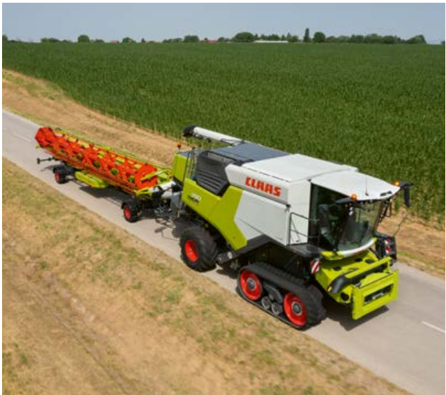
Alle TERRA TRAC Raupen sind bis 30 km/h voll straßentauglich und lassen sich komfortabler fahren als die Radmaschinen.
