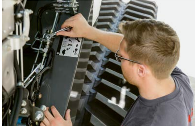
Die zwei Drehzahlbereiche des Dreschtrommelreduziergetriebes schalten Sie manuell über ein Hydraulikventil.
