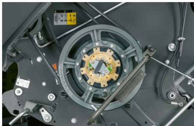
Otáčky řezačky slámy lze přizpůsobit Vašemu provozu jednoduše, rychle a bez použití nářadí.
