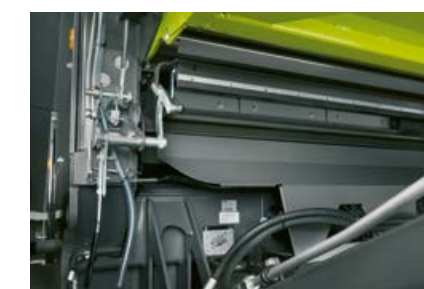
Velký žlab na zachycování kamenů lze jednoduše otevřít a vyprázdnit.
