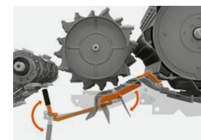
Klapky předního koše odklasní materiál a odstraní plevu.
