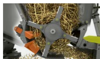
Protiotříska a výkyvný prvek dna řezačky slámy v SPECIAL CUT.
