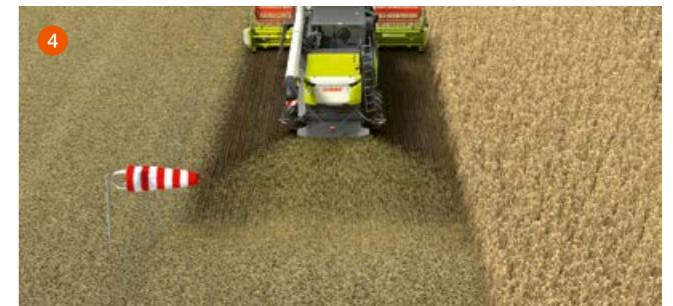
3 Senzorii din partea din spate a utilajului înregistrează intensitatea curențului lateral.
