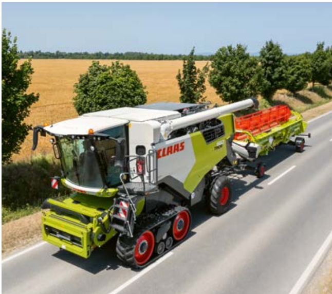
Alle TERRA TRAC-modellene er laget for sikker kjøring i opptil 30 km/t og kan kjøres like komfortabelt som skurtreskerne med hjul.
