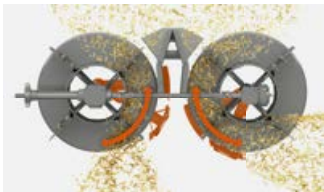
Radialspreder for effektiv halmbehandling med lavt effektbehov
