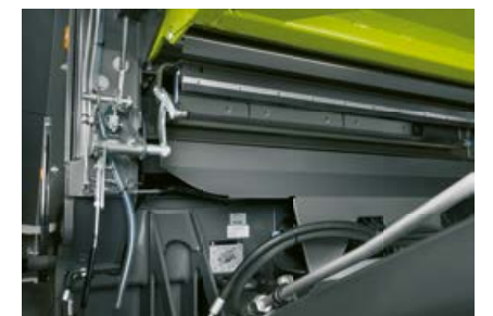
Den store steinfellen kan lett åpnes og tømmes.
