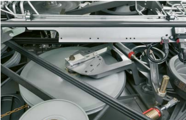
Profondeur de piquage des doigts dans le matelas de paille réglable.
