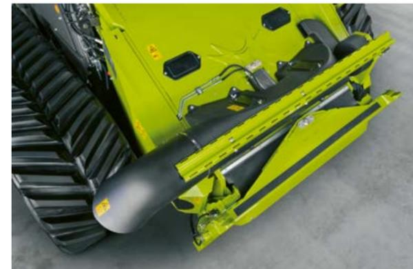
**Convoyeur à face avant réglable renforcé.**
