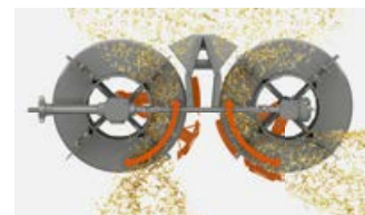
Radialverteiler für effiziente Strohverteilung bei minimalem Kraftaufwand
