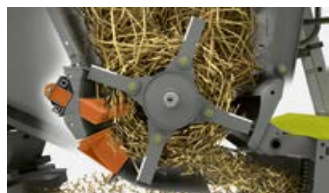
Gegenmesser und schwenkbares Bodenelement im SPECIAL CUT Häcksler
