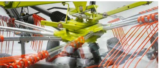
Kardanowe zawieszenie wimików: wimiki dostosowują się do konturów gleby – niezależnie od ciągnika.
