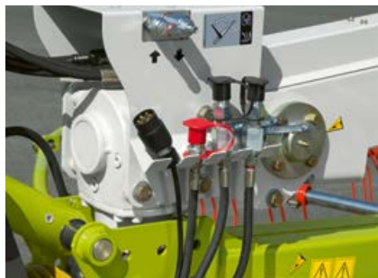
Seryjne hydrauliczne sterowanie sekwencyjne do czasowego przesunięcia podnoszenia i opuszczania przedniego i tylnego wirnika.
