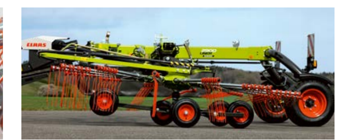
Effetto JET: durante il sollevamento o l'abbassamento la girante si comporta come un aereo in fase di decollo o atterraggio.
